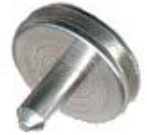
Abb. 11.12. Handelsüblicher Aluminiumprobenteller, auf dem die Proben für die REM fixiert werden.
